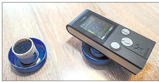
Бытовой дозиметр обнаружит следы распада радона на фильтрах, которыми чистят воду
