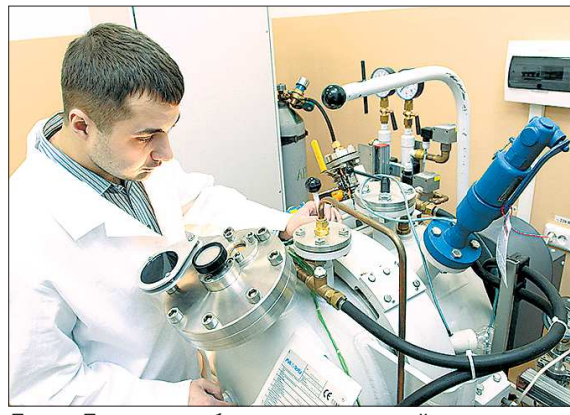
Денис Давыдов наблюдает за плавкой металлов в вакуумной индукционной печи
